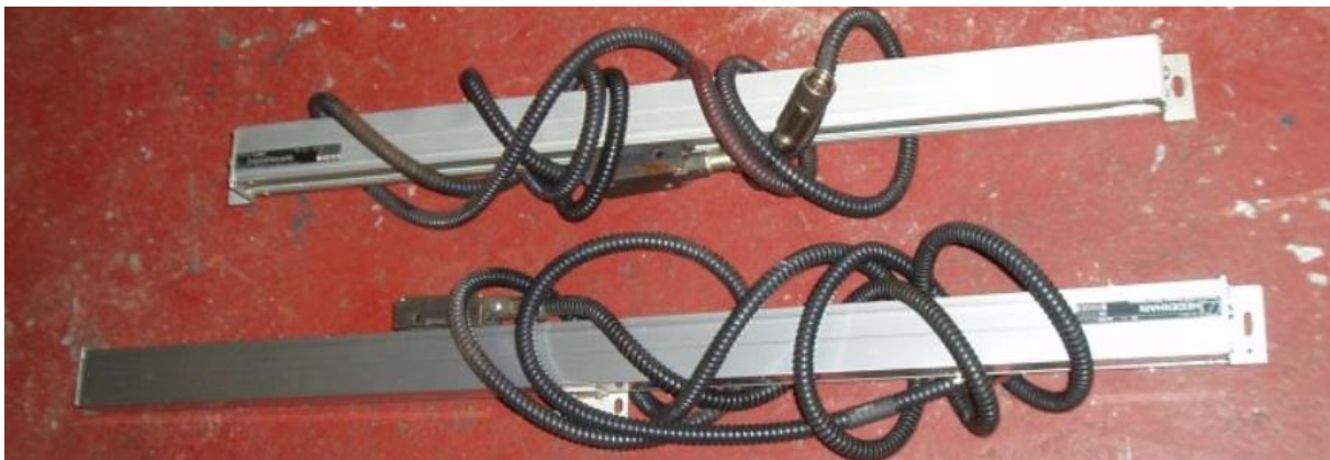
Slika 2 merilni letvi, kratka za X, dolga za Z, pred montažo na stružnico.
