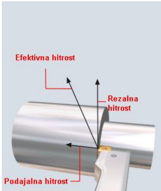
Slika 1 rezalno hitrost navajamo, kot da je vse skupaj na ravnini v m/min vir: http://egradivo.ecnm.si/ODR/poti_in_hitrosti.html
