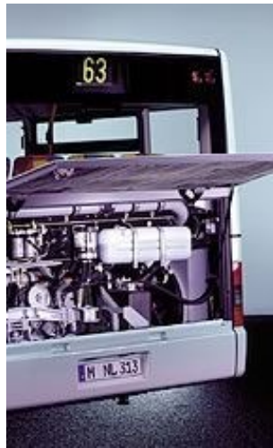
Slika 3.29: Vgradnja motorja v avtobusu Vir: www.iveco.com , www.man.com
