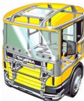
Slika 3.8: Ogrodje kabine tovornega vozila Vir: www.scania.com
