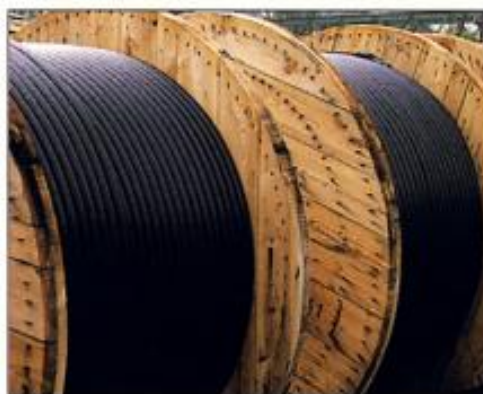
Slika 4 Električni kabli so izolirani s polivinilkloridom.
